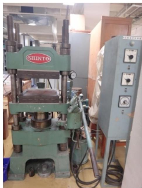
図 熱圧プレスによる圧縮加工
