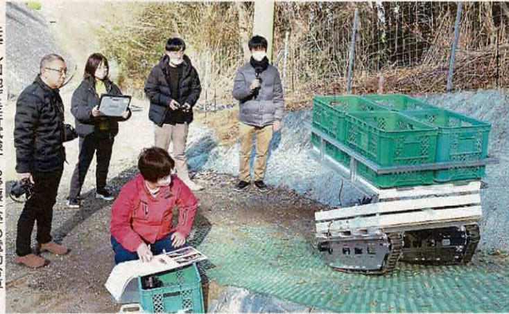
モデル園地で走行試験する愛媛大学の電動台車試作機（松山市で）
