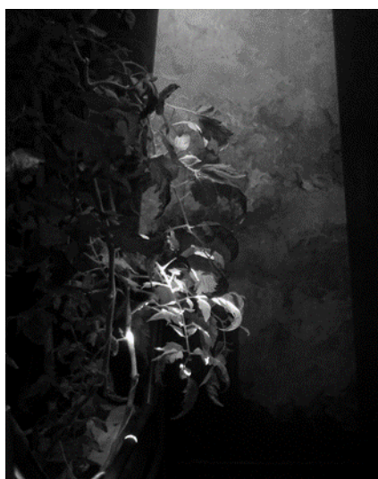
図 2 風洞チャンバー内でトマト周辺の気流の可視化計
