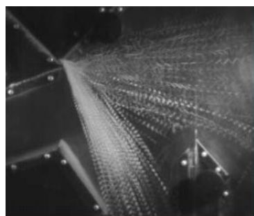
図 4 コンバイン内部の風選別の様子
