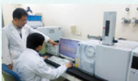
ガスクロマトグラフ質量分析装置による物質測定
