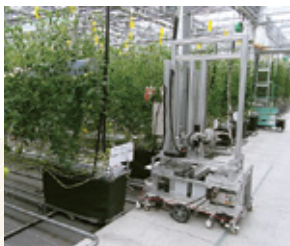
マルチオペレーションロボット（収穫ユニット）
