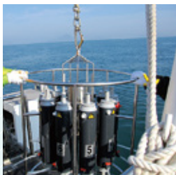
いろいろな深さの海水を 採取するための採水器
