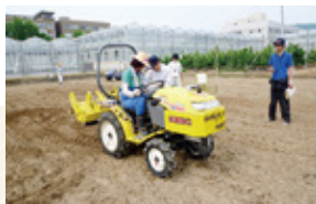
企業・愛媛県と共同開発した 電気トラクタの実験
