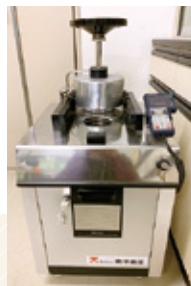
本研究室で使用している 高圧処理装置
