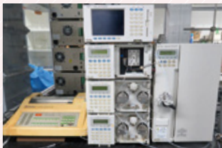
有用な化学物質の分析および精製に 用いる機器(HPLC)
