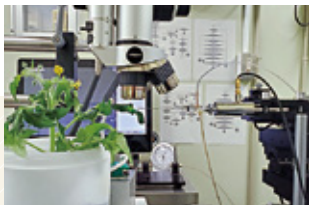
トマト1細胞での水分状態・代謝産物計測の様子
