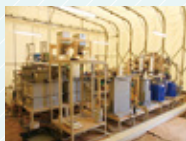
汚泥からのリン回収装置
