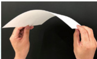
光触媒と吸着材を配合した機能紙
